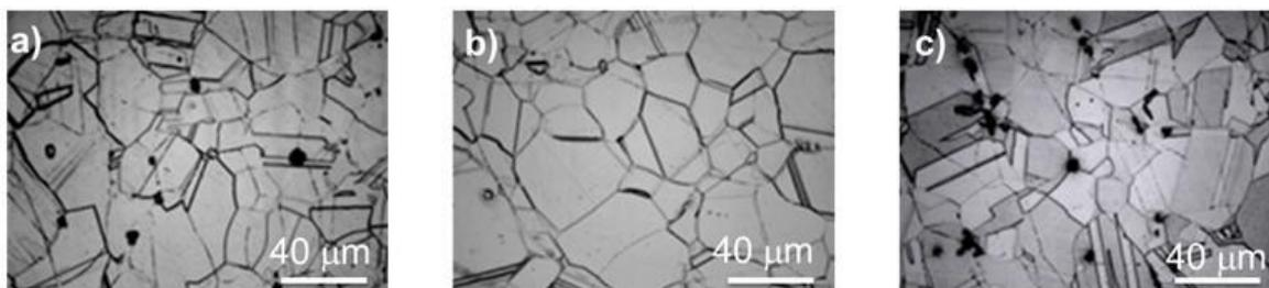
**Figure 2.** Optical micrographs of Inconel 718. a) transversal 50x, b) longitudinal 50x y c) superficial 50x.
