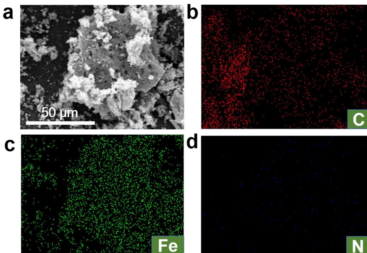
**Figure 6.** SEM-EDX elemental mapping images of Fe<sub>3</sub>-600: (a) SEM image, (b) C, (c) Fe, (d) N.
